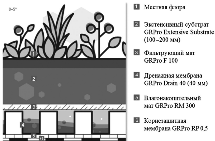
Рис. 1. Устройство природной «зеленой» кровли
